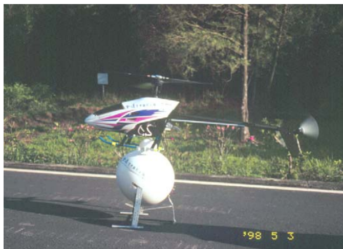
圖 1 旋翼直昇機 (1) 載荷攝影機及控制系統構成之球體
