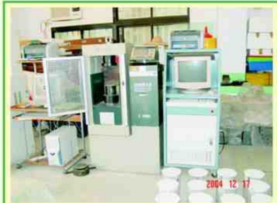
200 ton 混凝土抗壓強度試驗機
