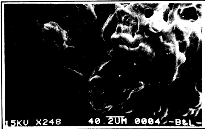
● 包覆著阿拉伯膠及動物膠溶液的羅勤(九層塔)精油之多核微膠囊
