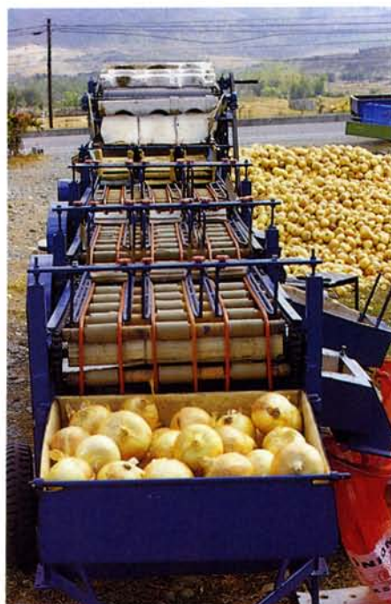
▶ 圖二：開發完成具三條分級線之鏈桿皮帶組合式分級機
