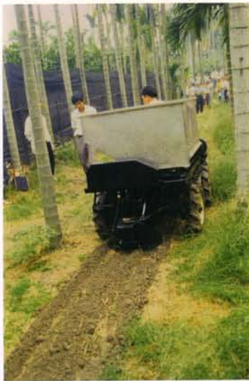
圖三 中置型鏈式挖溝施肥機在行株距整齊的果園中開溝施肥堆肥作業情形
