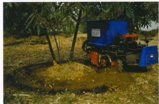
圖六 側置型鏈式開溝施肥機在竹筍園中試驗的情形
