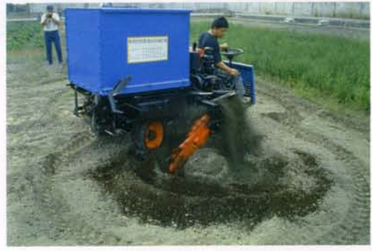
圖四 側置型鏈式開溝施肥機挖掘環溝的情形
