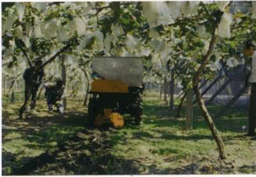
圖二 中置型鏈式挖溝施肥機在葡萄園開溝施肥堆肥作業情形
