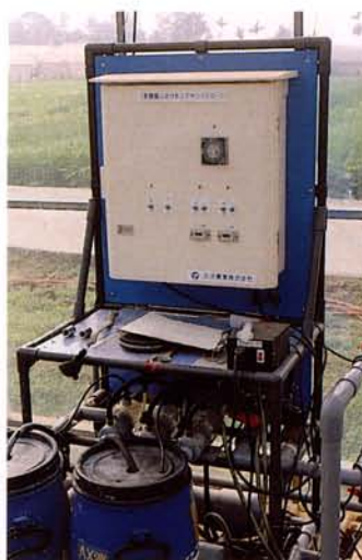
圖八：自動灌溉和施肥控制器。
