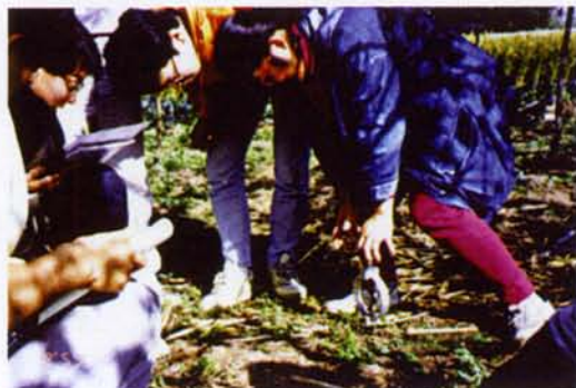
圖五、利用穿刺阻力計可偵測在土壤剖面不同深度中之密實特性
