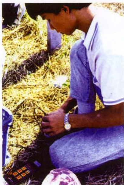
圖六、利用攜帶型PH計可進行田間之PH速測
