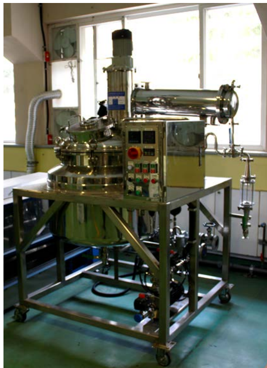
圖 4、「水解、發酵及蒸餾三合一」生質酒精生產設備
